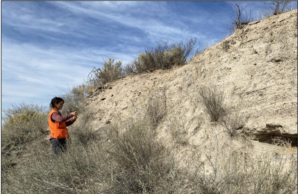
Figura 3-21. : Sedimentos aluviales aglomerádicos estratificados sin diagenizar
