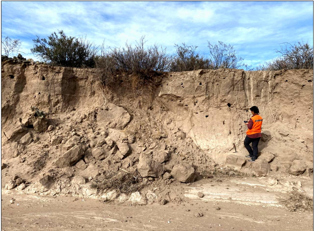
Figura 3-16, : Detalle de los depósitos limo-arcillosos en corte. Prospección de los niveles consolidados, no cementados
