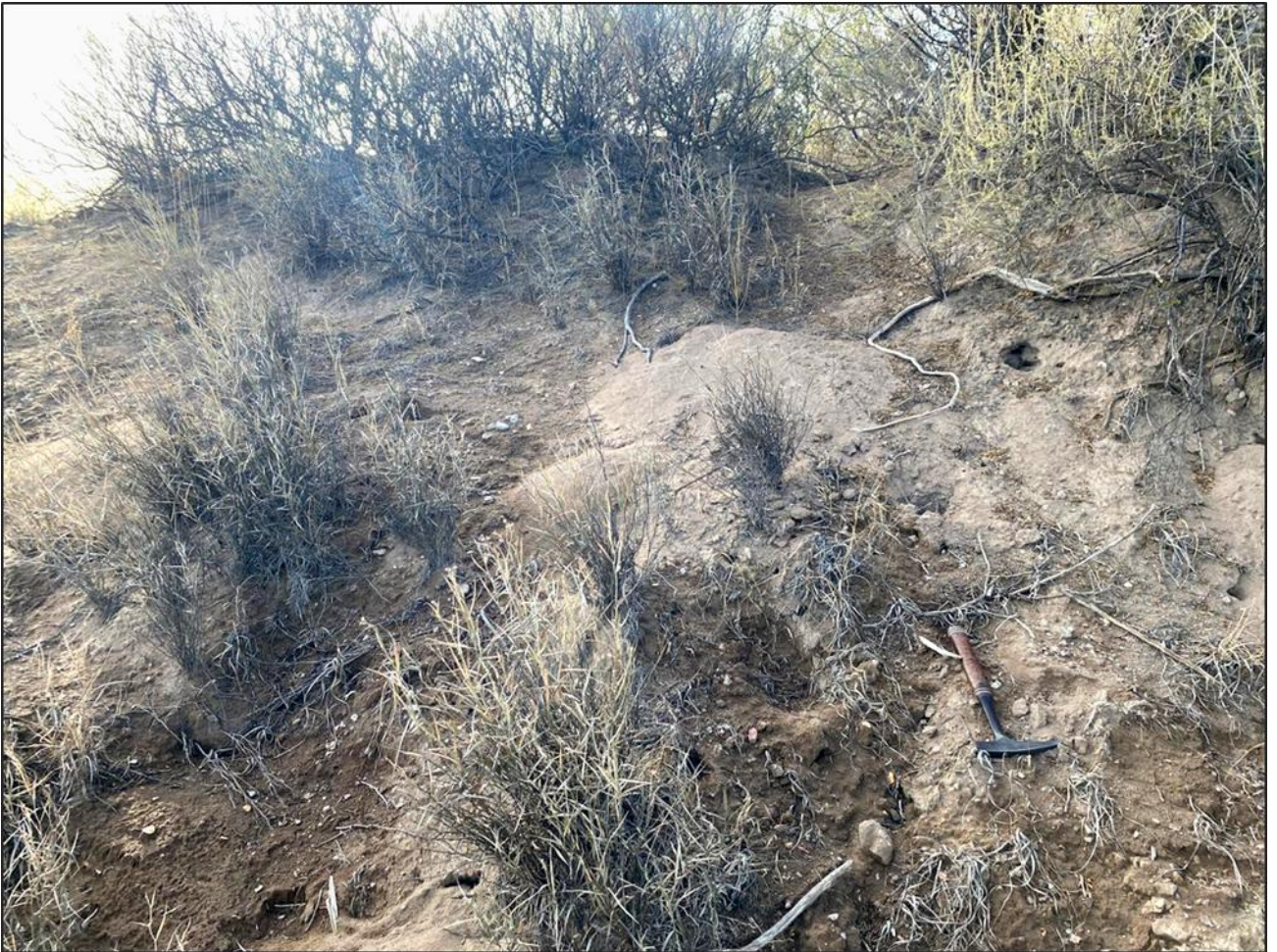
Figura 3-10, Detalle de los sedimentos limo-arcillosos recientes no consolidados
