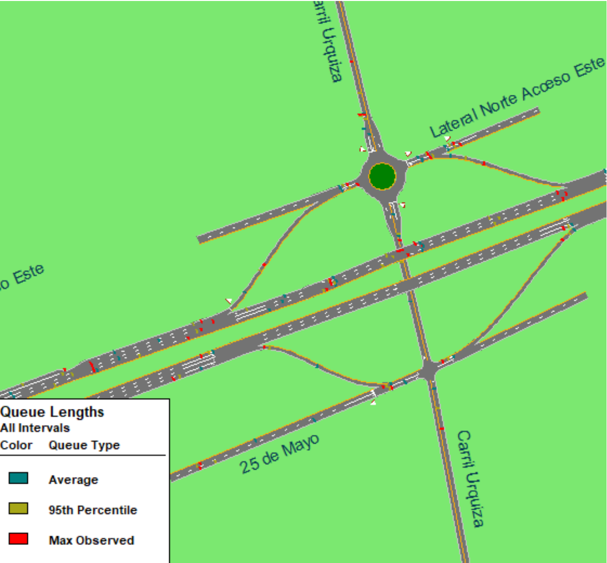
FIG. N° 62: Colas en escenario SITUACIÓN FUTURA en Intercambiador Urquiza-RNN7
