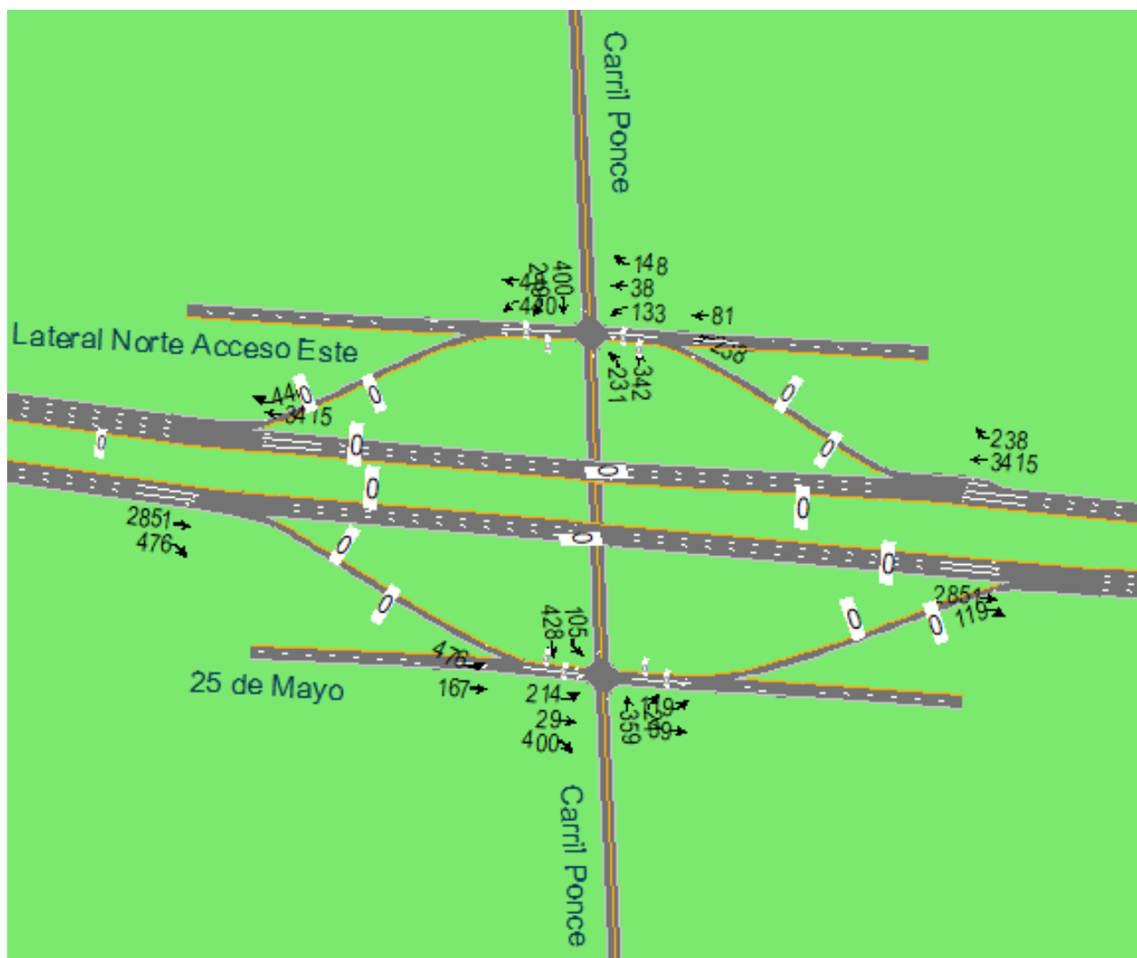
FIG. N° 45: Volúmenes horarios en escenario SITUACIÓN FUTURA (CON PROYECTO) en Intercambiador Ponce-RNN7
