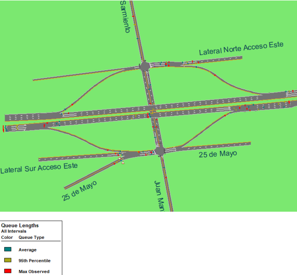
FIG. N° 24: Colas en escenario SITUACIÓN ACTUAL en Intercambiador Sarmiento-Estrada-RNN7
