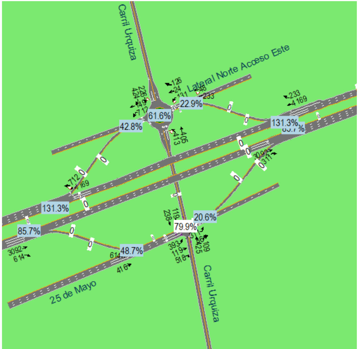
FIG. N° 84: ICU en escenario SITUACIÓN FUTURA CON PROPUESTA DE MEJORA en Intercambiador Urquiza-RNN°7
