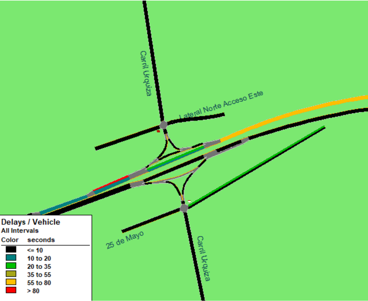
FIG. N° 15: Demoras en escenario SITUACIÓN ACTUAL en Intercambiador Urquiza-RNN°7
