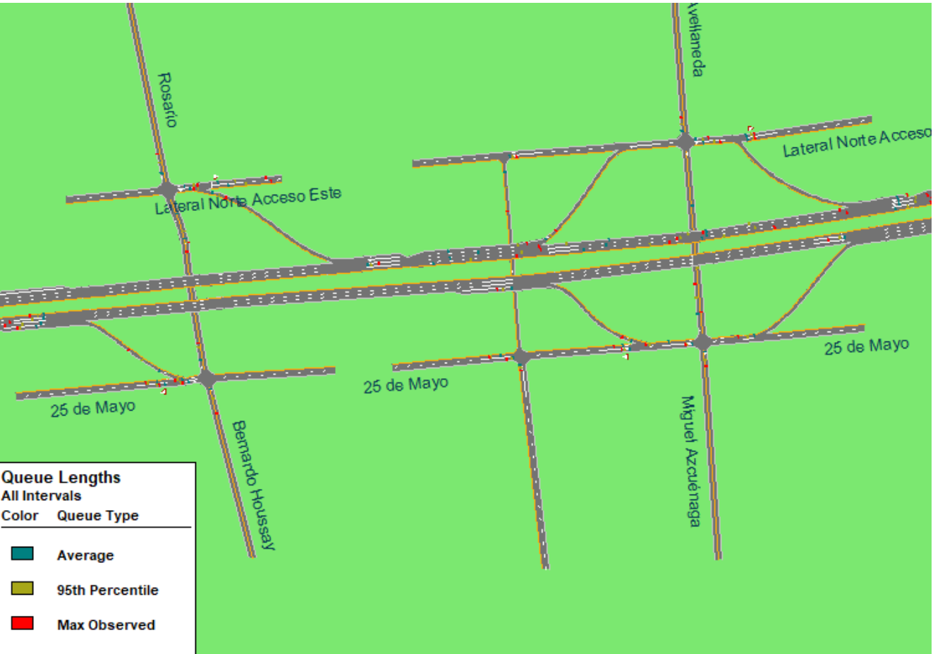
FIG. N° 80: Colas en escenario SITUACIÓN FUTURA CON PROPUESTA DE MEJORA en Intercambiador Rosario-Houssay y Avellaneda-Azcúenaga-RNN7
