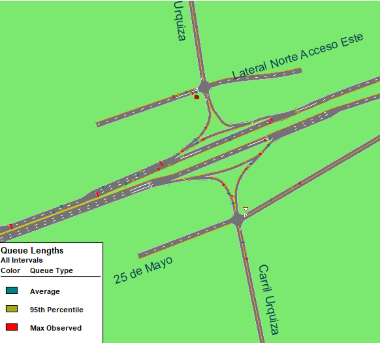
FIG. N° 29: Colas en escenario SITUACIÓN ACTUAL en Intercambiador Urquiza-RNN°7
