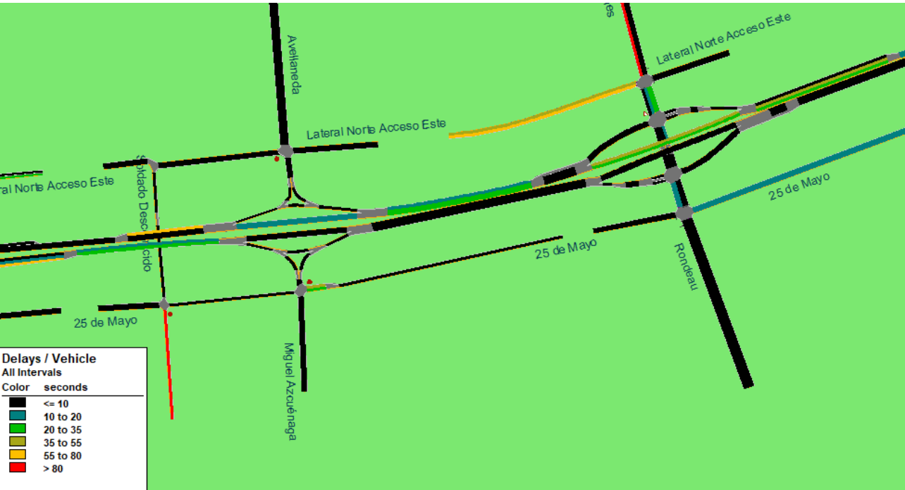
FIG. N° 13: Demoras en escenario SITUACIÓN ACTUAL en Intercambiador Avellaneda-Azcuénaga y Arenales-Rondeau-RNN°7
