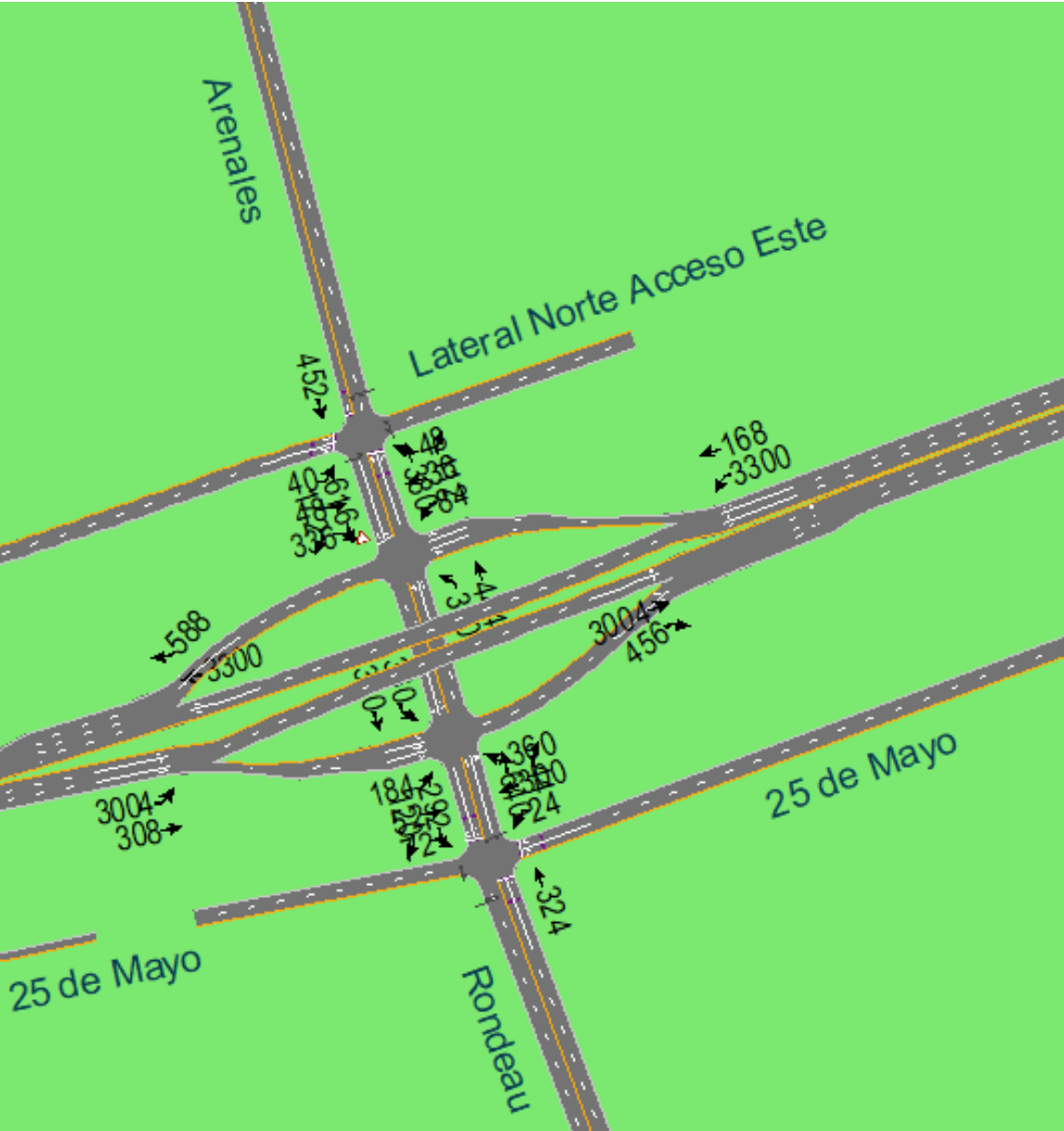
FIG. N° 7: Volúmenes horarios actuales en Intercambiador Arenales-Rondeau-RNNº7
