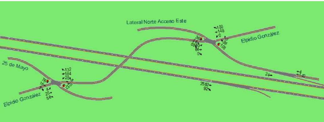
FIG. N° 10: Volúmenes horarios actuales en Intercambiador E. González-RNN°7
