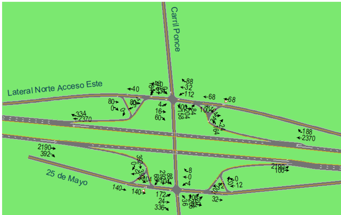
FIG. N° 11: Volúmenes horarios actuales en Intercambiador carril Ponce -RNN°7
