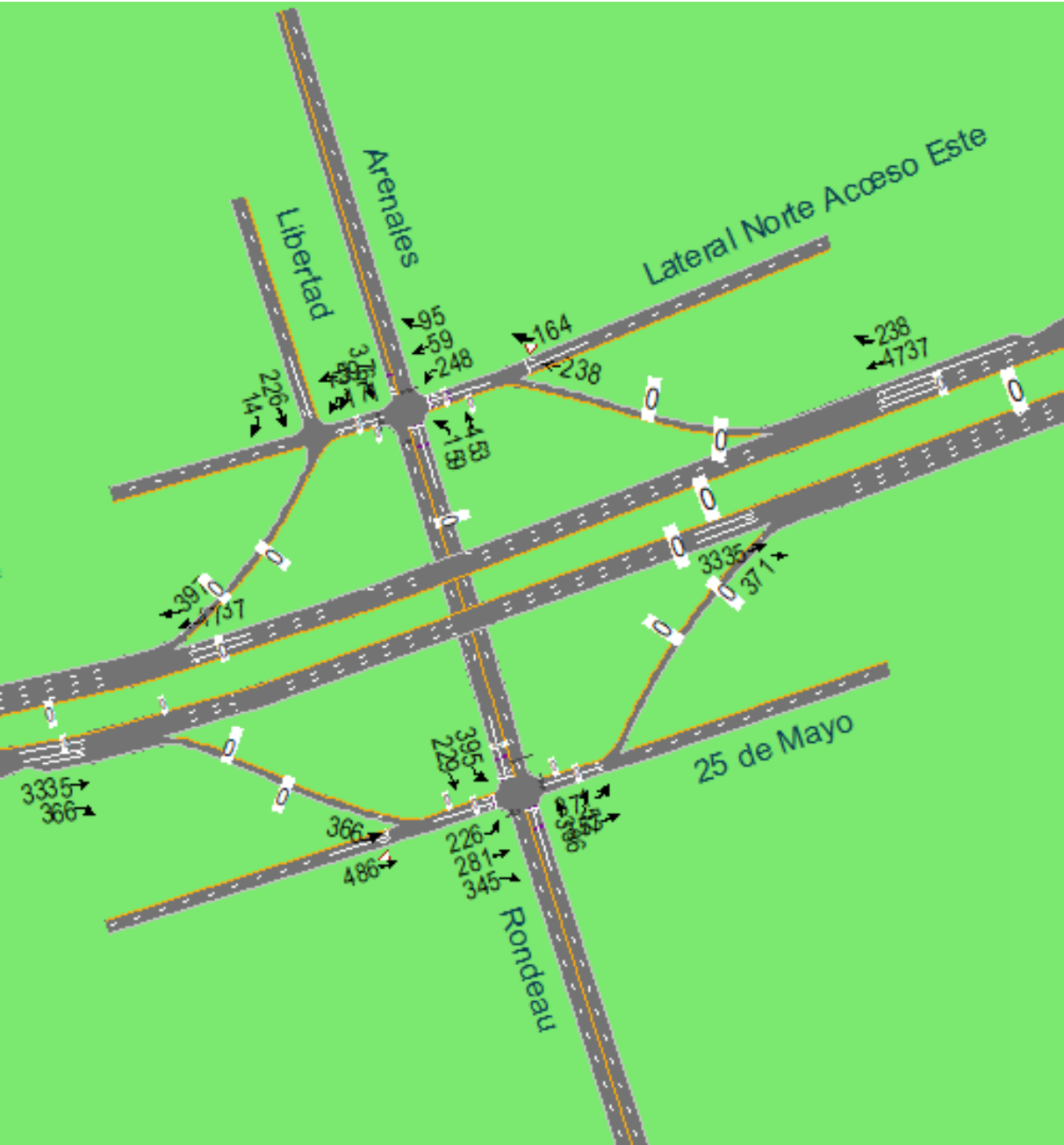
FIG. Nº 41: Volúmenes horarios en escenario SITUACIÓN FUTURA (CON PROYECTO) en Intercambiador Arenales-Rondeau-RNN7
