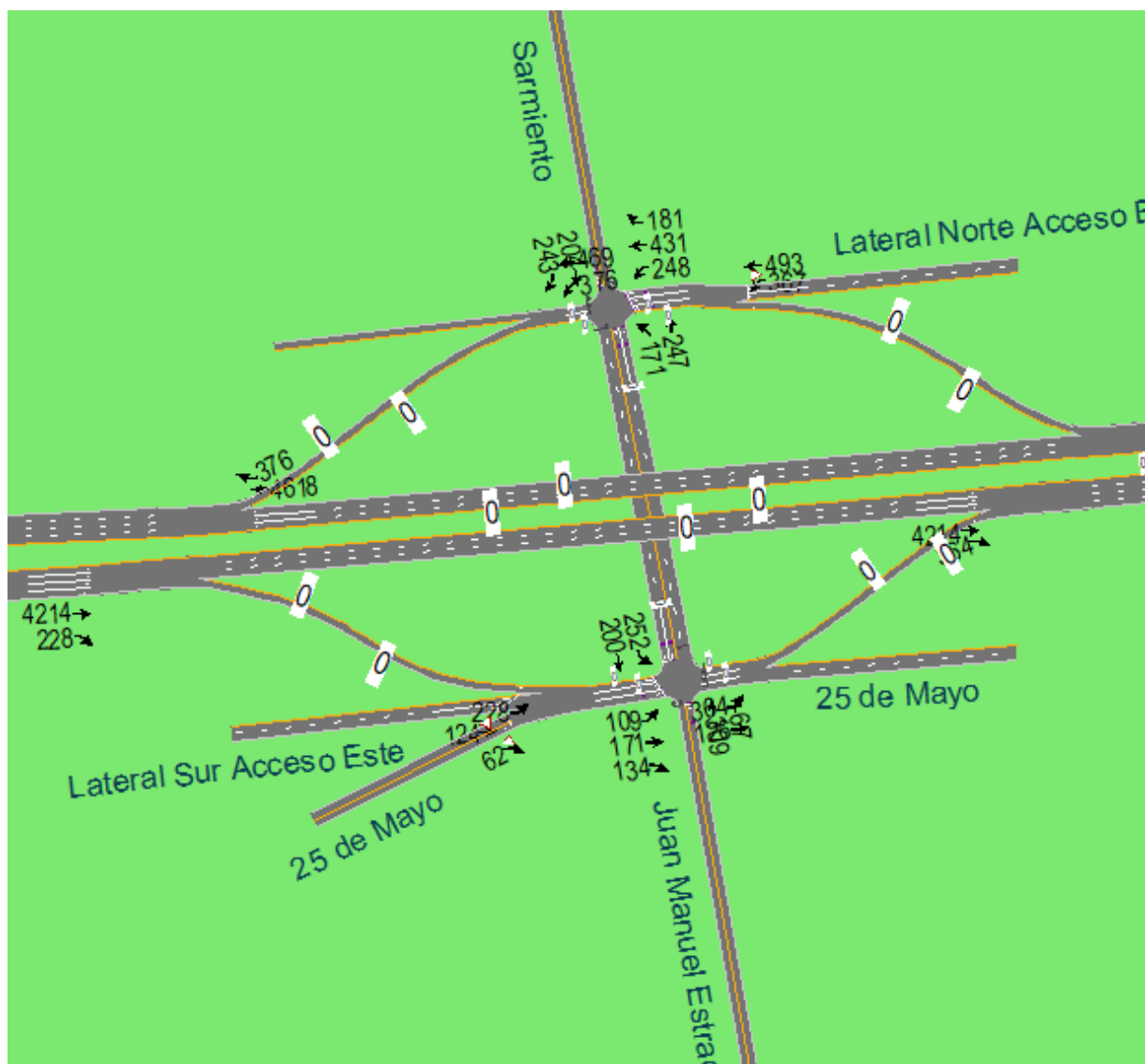
FIG. N° 38: Volúmenes horarios en escenario SITUACIÓN FUTURA (CON PROYECTO) en Intercambiador Sarmiento-Estrada-RNNº7
