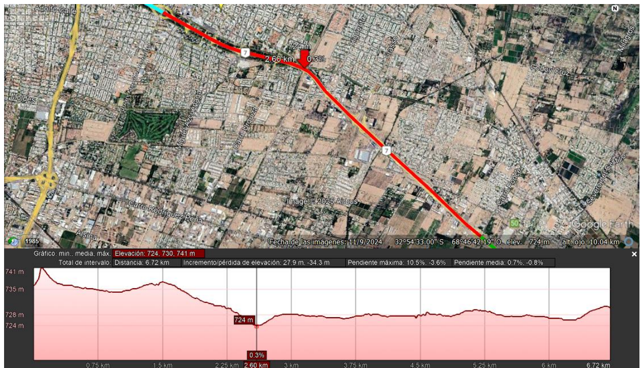
Figura 11: Perfil de Elevación Longitudinal Tramo 2
