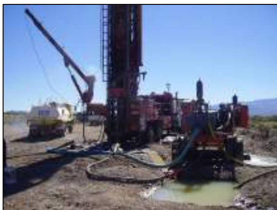
Fotos 6 y 7: detalle de las tareas de perforación correspondientes al pozo SJ_PM_3. Se aprecian el equipo de perforación y sistemas auxiliares dispuestos en la locación
