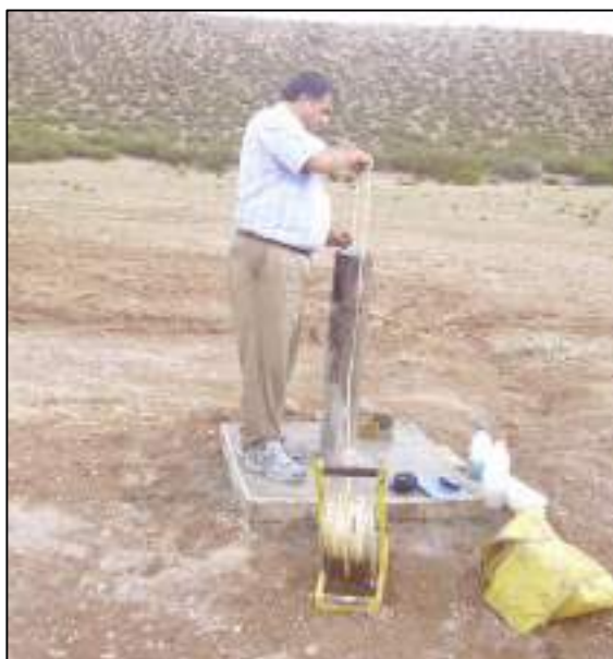
Fotos 2 y 3: detalle de las tareas de perforación correspondientes al pozo SJ_PM_1. La imagen de la izquierda corresponde a mediciones del nivel de agua en boca de pozo, registrándose un acuífero colgado a los 20 metros y el acuífero freático a los 50,68 m. La fotografía de la derecha muestra en detalle el caño de protección de superficie, de una longitud de 1.05 m y diámetro de 6 ½", con el soporte para asegurar la tapa. En su interior se observa la cañería PVC de 4".
