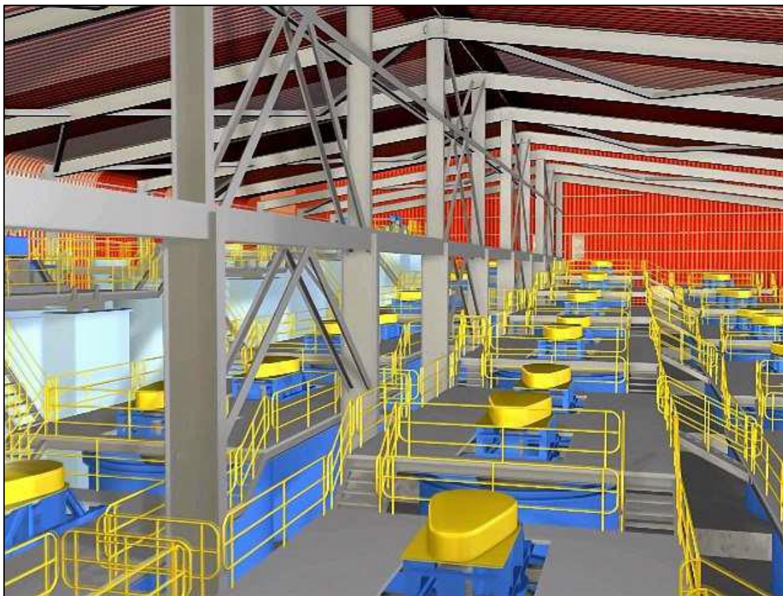
Figura 17.8 Vista del equipamiento de flotación
