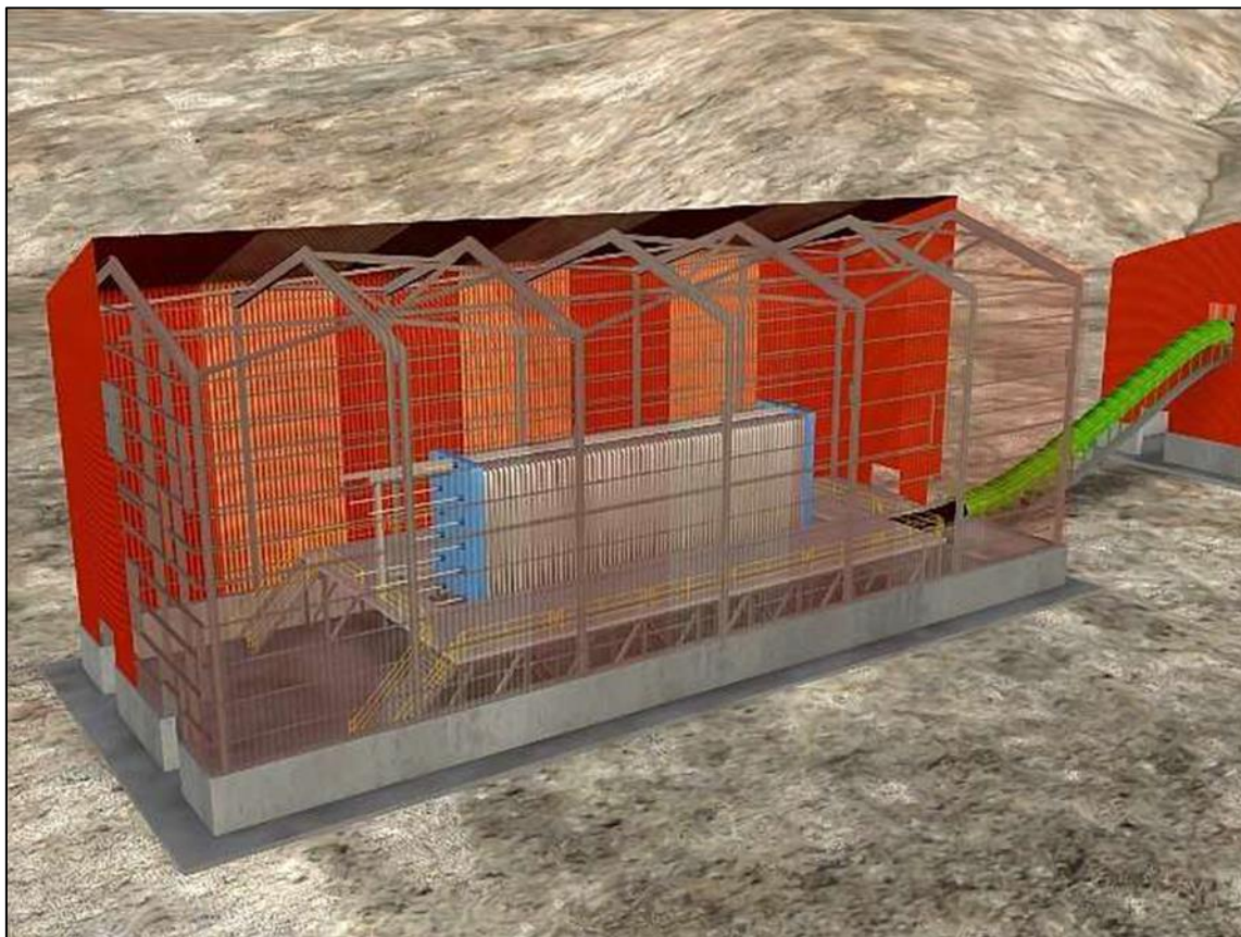
Figura 17.10 Vista del filtro prensa, cintra transportadora y depósito de almacenamiento del concentrado seco.
